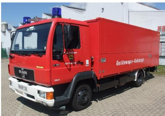
Der Landkreis Heilbronn befindet sich aktuell in der Ersatzbeschaffung der zwei im Landkreis vorgehaltenen Gerätewagen Gefahrgut (Bj. 1995), bei uns stationiert in der Abteilung Bad Rappenau. Im Rahmen eines vom Kreistag beschlossenen Wechselladerkonzeptes des Kreises werden diese Fahrzeuge als Wechsellader (WLF) mit zugehörigem Abrollbehälter Gefahrgut (AB G) beschafft. Die Erstellung der diesbezüglich erforderlichen Leistungsbeschreibungen erfolgte in
