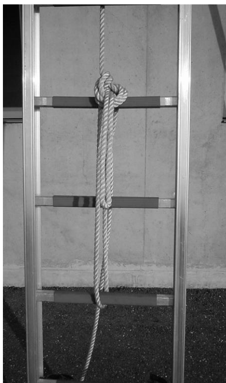
Sicherungsknoten bei der Schiebleiter: Mindestens drei Sprossen umschlingen, Mastwurf gestochen über der Sprosse ODER Mastwurf gestochen unter der Sprosse ODER Mastwurf gestochen links und rechts neben Zugseil
