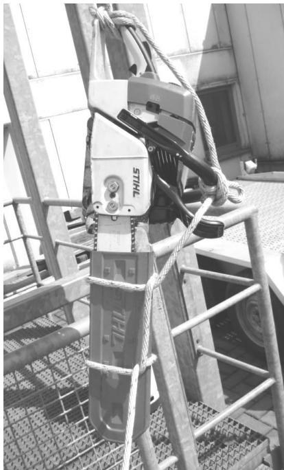
Mastwurf – Mastwurf – Halbschlag – Halbschlag
